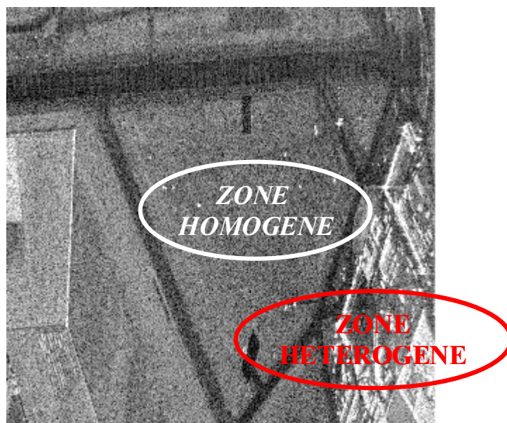
Figure III.2 Exemples de zones homogènes et hétérogènes sur une image SAR
