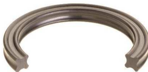
Figure 2.13 - Illustration d'un joint quadrilobe [Satoriseal 09], la section comporte quatre lobes qui offre une bonne étanchéité avec des frottements réduits à moitié par rapport au joint torique classique [Chevalier 03].
