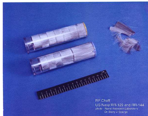
FIG. 3.8 – Leurres électromagnétiques (chaff) avec leurs douilles.
