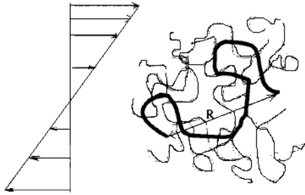
Figure 1.5 : Une chaîne test, représentée par le vecteur bout à bout R , enchevêtrée avec les autres chaînes pendant l'écoulement ; la vitesse relative est de l'ordre R\dot{\gamma} .
