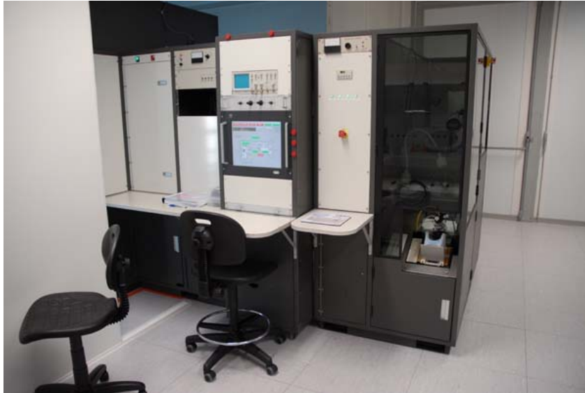
Figure III-7 : l'implanteur ionique Axcelis Eaton NOVA 4206 du LAAS
