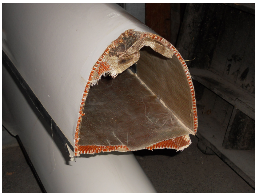
Figure I.4 – Coupe d'un bateau d'aviron endommagé montrant sa structure composite fibre de verre/nid d'abeille
