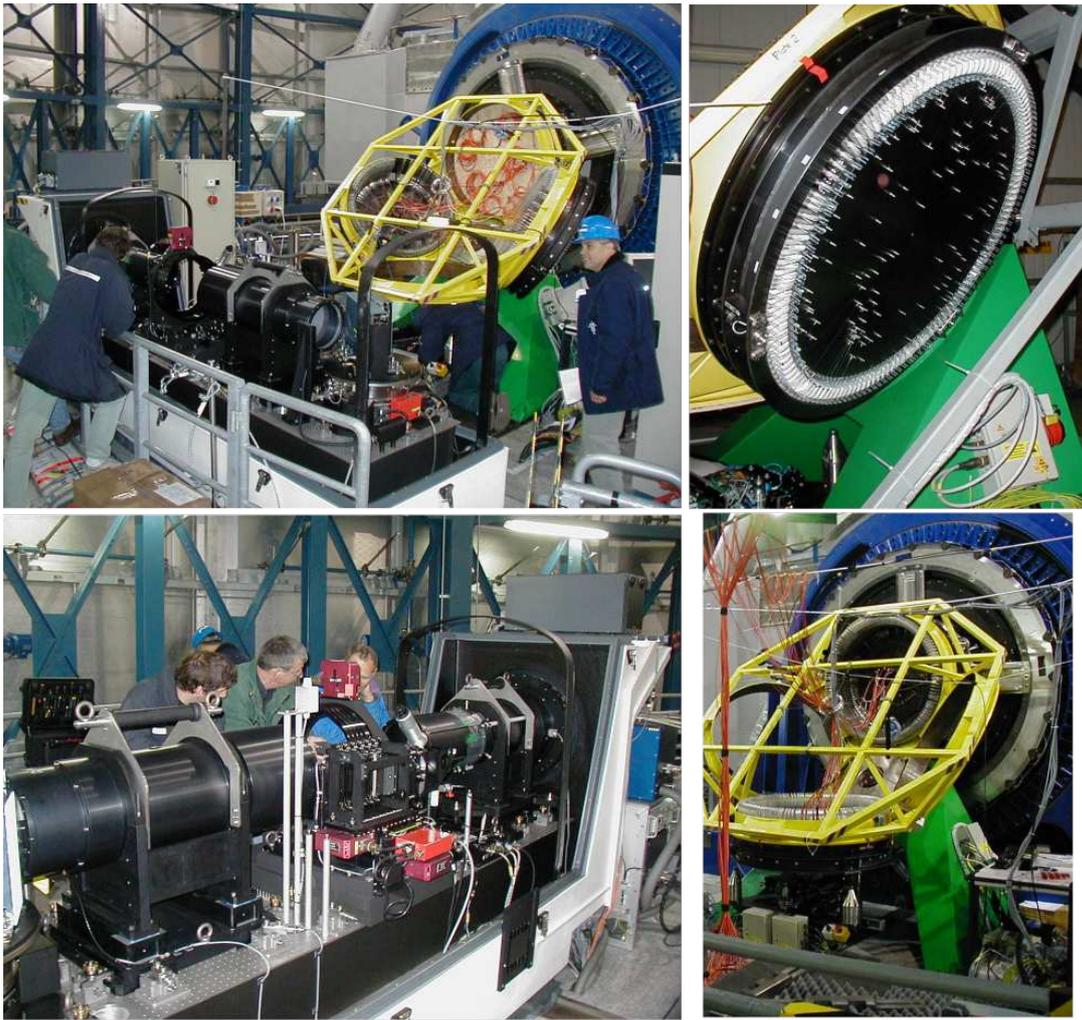
FIGURE 3.6 – Images de FLAMES. De haut en bas et de gauche à droite, une vue du spectroscopie GIRAFFE avec OzPoz, une vue du plateau avec dessus les fibres optiques maintenues par des boutons magnétiques, une autre vue de GIRAFFE et enfin une vue de l'OzPoz. Photo provenant du site de L'ESO dans la section décrivant FLAMES.
