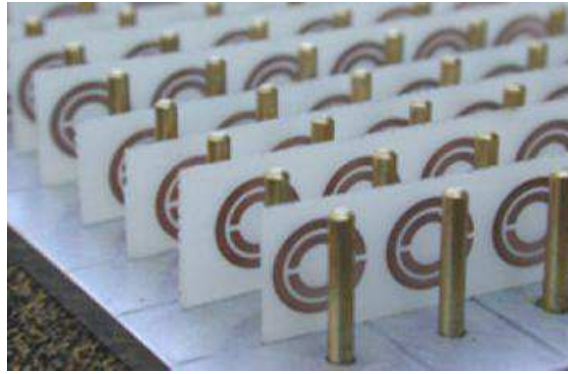
Figure 1.8 : La structure proposée par D. Smith qui combine les fils minces et les SRR pour avoir un milieu doublement négatif (métamatériaux) [2]
