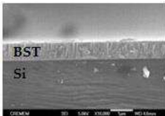
Figure 4.8 : micrographie MEB du film BST déposé sur silicium [77].
