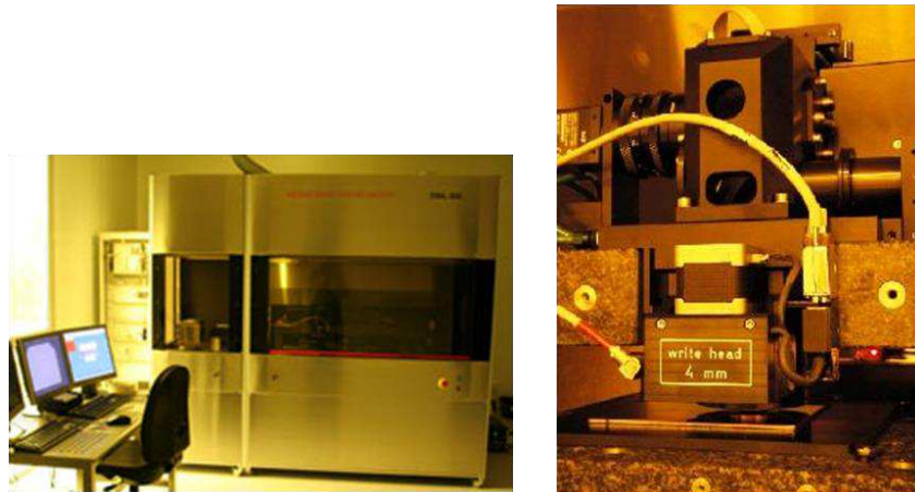
Figure 4.10 : Insolateur laser Heidelberg DWL 200 utilisé pour la gravure.
