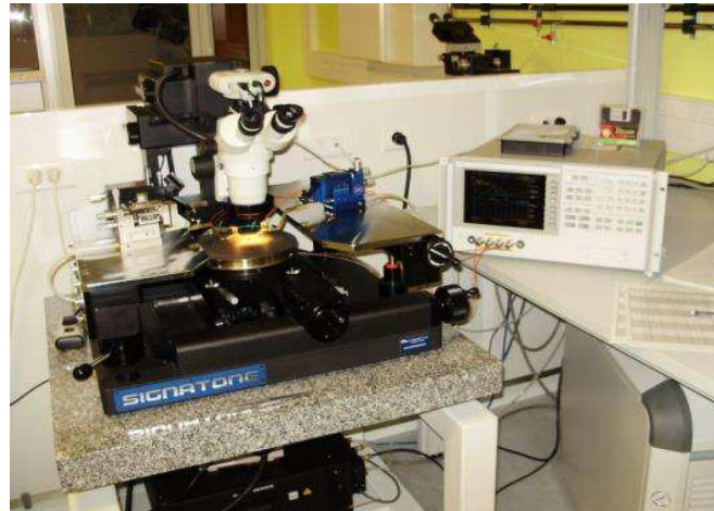
Figure 4.12 : Banc de mesure basé sur une station sous pointe Sigmatone et un analyseur d'impédance Agilent 4294A utilisé pour les mesures des capacités MIM.
