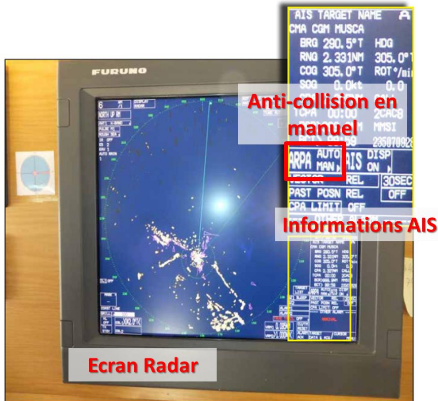
Figure 4-18. Ecran radar à bord du navire Paula C au moment de l'accident et affichage des données AIS
