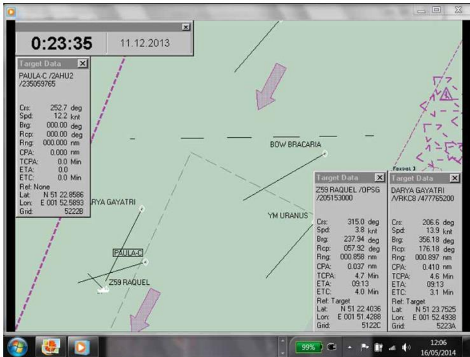
Figure 4-16. Ecran de contrôle en centre de surveillance, les navires Paula-C et Darya Gayatri en navigation proche et parallèle, navire Raquel en manœuvre d'évitement
