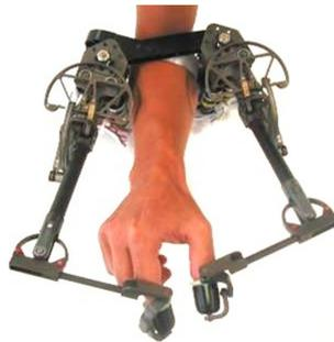
FIGURE 2.15: Interface à deux doigts PERCRO Pure Form (FRISOLI et al. 2007).
