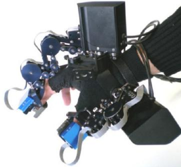
FIGURE 2.13: Interface à deux doigts PERCRO HAPTEX (FONTANA, BERGAMASCO et SAL-
