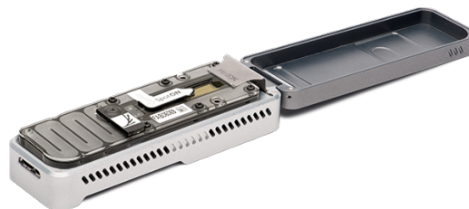
Figure 1.22: Un des très gros avantages du système de séquençage de type nanopore est qu'il utilise un dispositif très petit et peu onéreux, on voit ici le Mi-ion d'Oxford Nanopore qui est juste une grosse clé USB connectée directement à un PC (non représenté).
