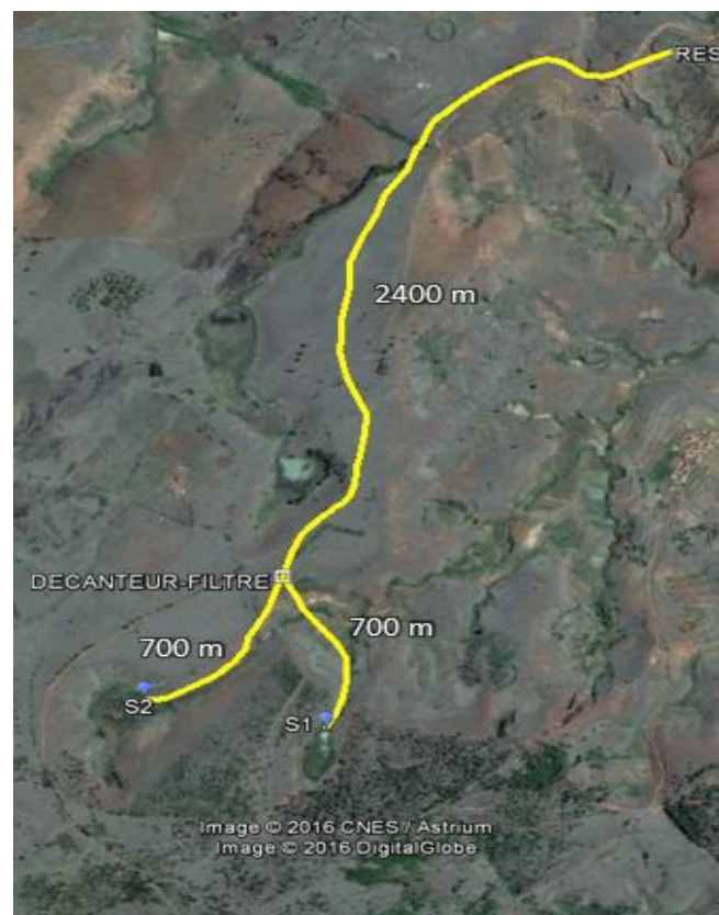
Figure 06. Le réseau d'amenée
