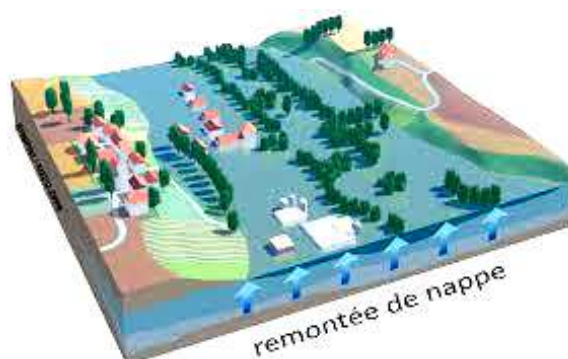
Figure3. Inondation par remontée de nappe (MEMENTO DU MAIRE, 2017)
