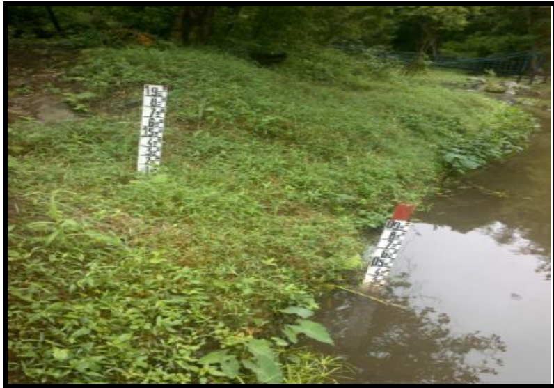
Photo 3 : Limnimètres installés en rive gauche
