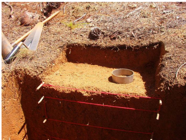
Figure 3-5 : Photo du prélèvement des échantillons de sol à cylindre
