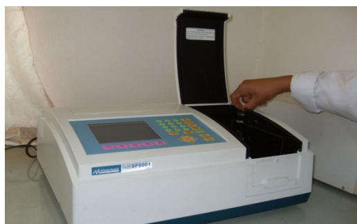
Figure 3-6 : Photo de la spectrophotométrie en ultraviolet (190-1100 nm) (Metertech SP8001)
