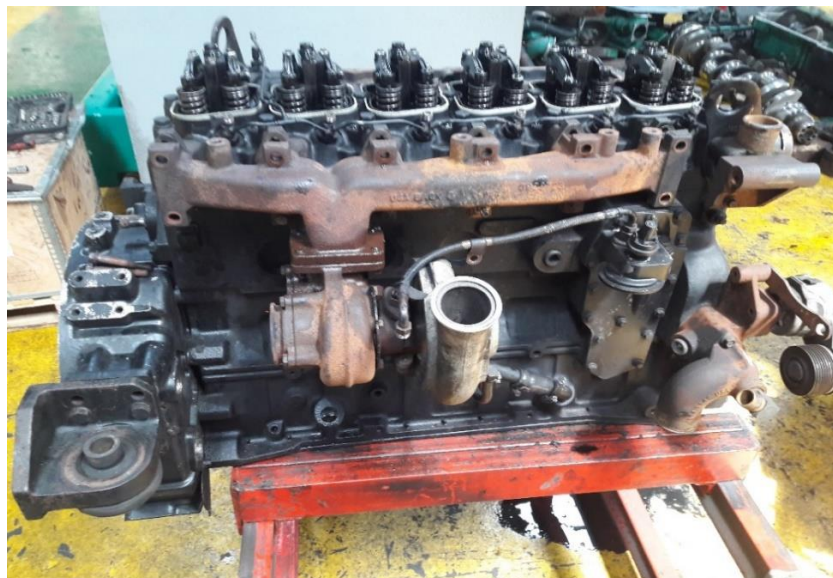
Photo 1 Moteur QSB5.9 pour camion poids moyen
