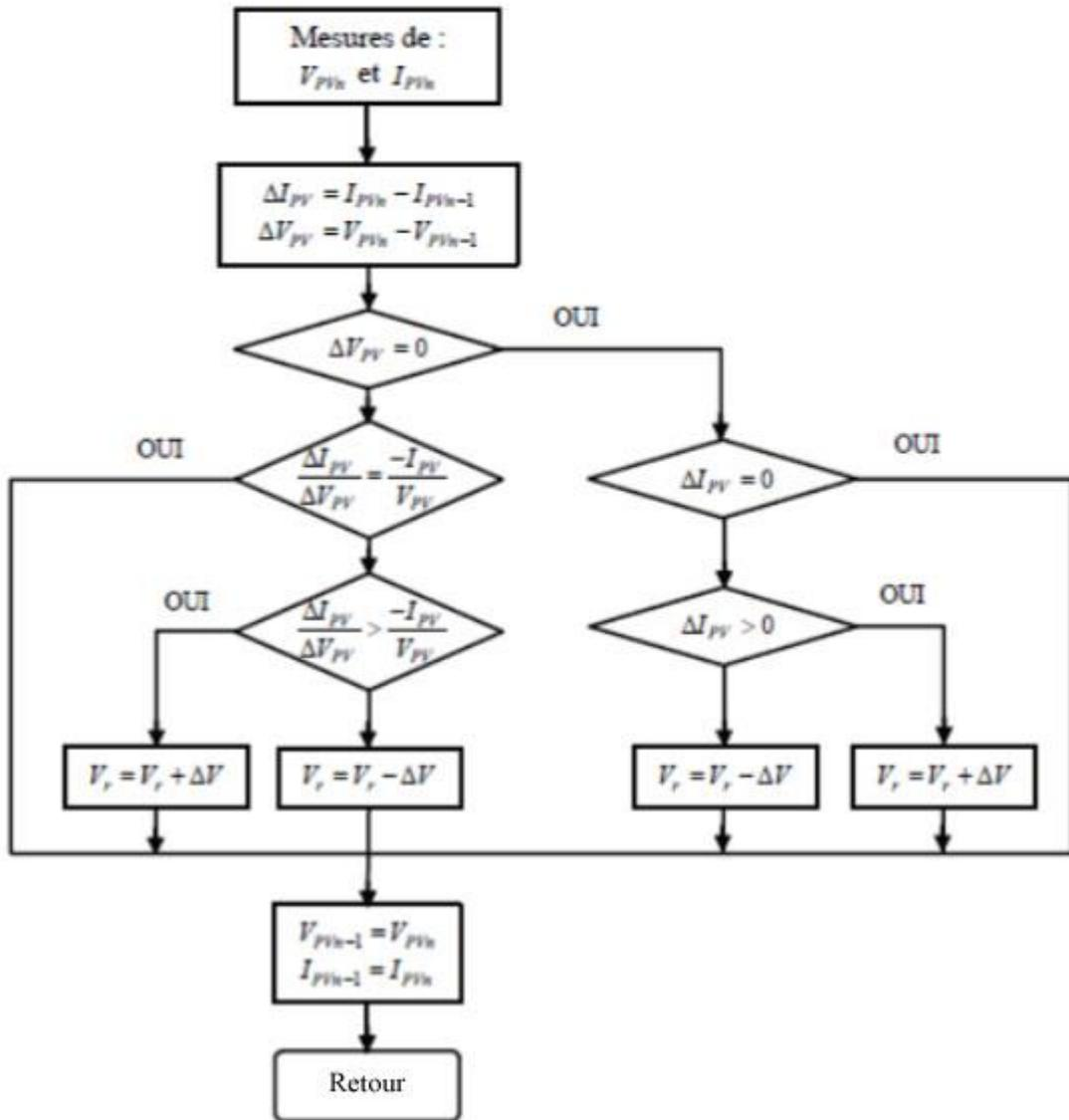
Figure 2. 8: Algorithme d'une commande MPPT basée sur la méthode IncCond
