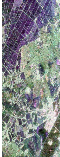
Fig.2.2 : Représentation de Pauli \{R;V;B\} = \{S_{HH}-S_{VV}; 2*S_{HV}; S_{HH}+S_{VV}\} Image RAMSES, bande P, St Germain d'Esteuil
