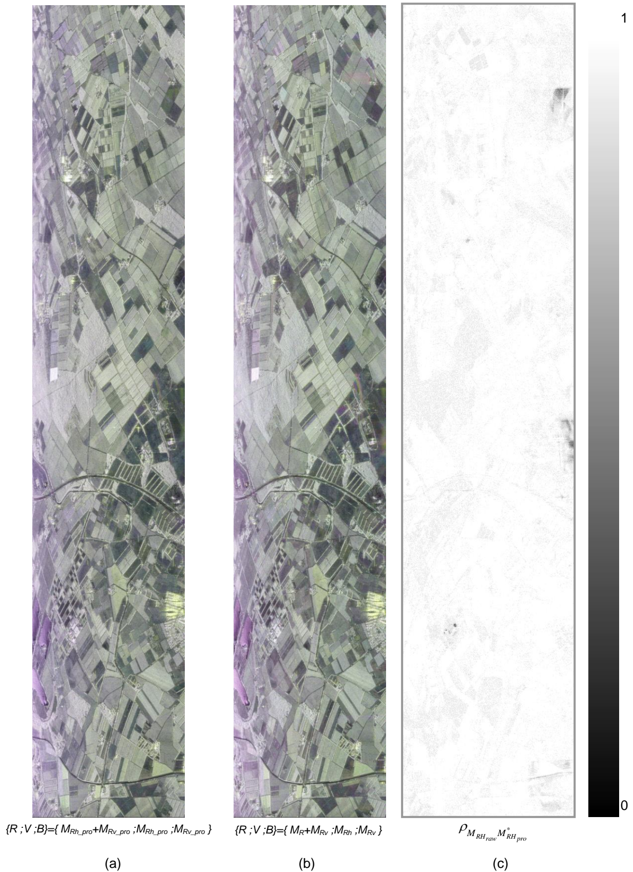
Fig.9.1 : (a) Images \{R;V;B\}=\{M_{Rh}+M_{Rv};M_{Rh};M_{Rv}\} issues des données full-pol traitées et calibrées, (b) \{R;V;B\}=\{M_{Rh}+M_{Rv};M_{Rh};M_{Rv}\} issues des données full-pol brutes et (c) cohérence entre les deux images compact-pol. Données SETHI, bande L acquises sur la zone de Garons lors de la campagne ENVIRO de juin 2009.
