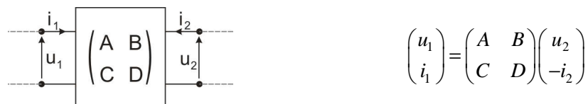
Fig. II.7 – Illustration d'un quadripôle. Sa matrice de transmission permet de relier les tensions et courants d'entrée et de sortie.
