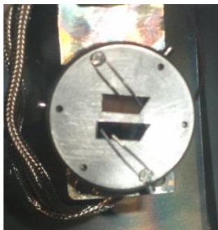
Figure IV-1 : Montage des échantillons InAs(111)-A et InAs(111)-B dans notre laboratoire a) et à MAX-lab b).
