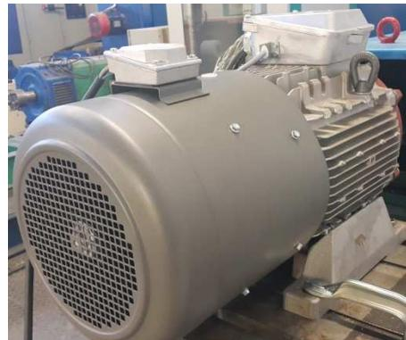
(b) Moteur du prototype avec la ventilation forcée
