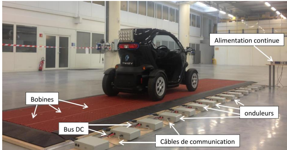
Figure I-15 : Système DWPT développé par Renault-Supélec [5].
