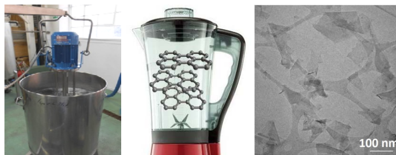
Figure 31 : Images d'exfoliation du graphène à l'aide d'un mixeur, et images TEM de feuillets produits par cette méthode [116].
