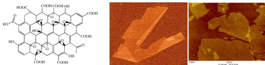
Figure 29 : Représentation d'un feuillet de graphène ayant des défauts de structure dus à la création de liaisons en bordure et au cœur du feuillet, image MEB de Gox déposé sur substrat [129].
