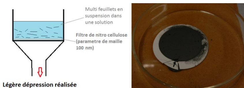
Figure 38: A gauche schéma d'un Buchner servant à filtrer une suspension de graphène, à droite photo d'un film.
