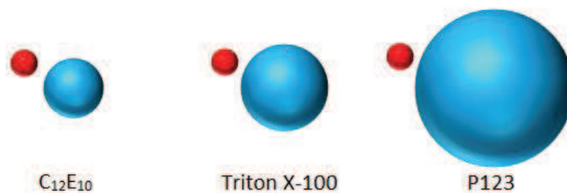
Figure 85 : Représentation du volume d'un complexe (●) par rapport à celui d'une micelle des tensioactifs C 12 E 10 , Triton X-100 et P123
