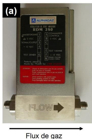
Figure II - 10 : (a) photographie d'un régulateur de débit massique, la flèche indique le sens du gaz ; (b) facteur de conversion massique des gaz utilisés dans ce travail de thèse ; (c) débit d'un gaz donné par rapport à celui de l'argon.
