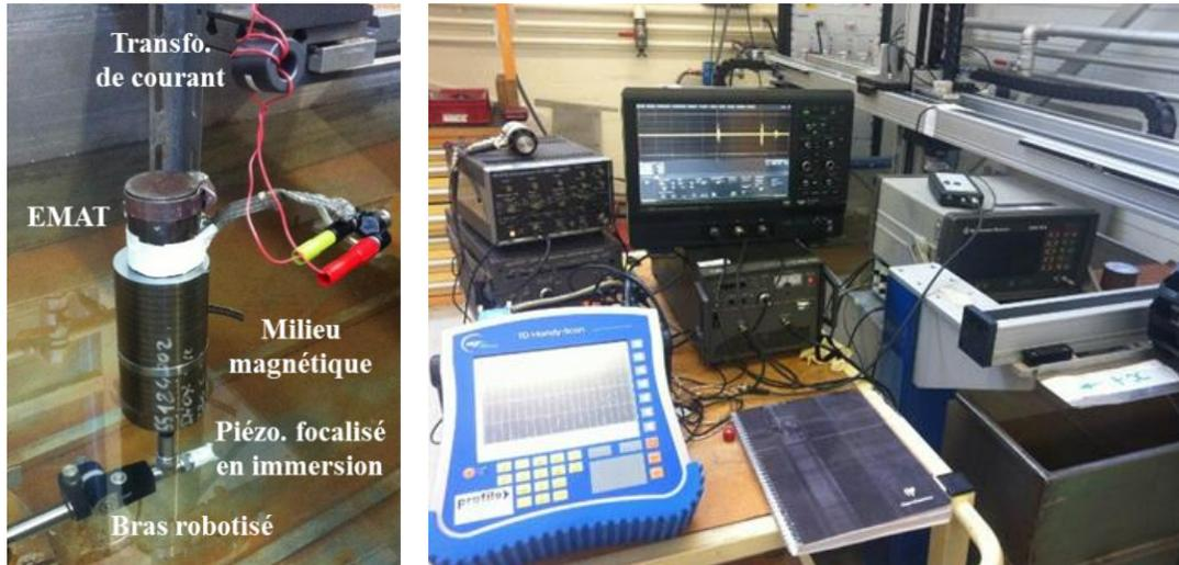
*Figure 5.108 : Montage expérimental pour la caractérisation en cuve du champ ultrasonore transmis par EMAT dans une pièce ferromagnétique à l'aide d'un transducteur piézoélectrique focalisé en immersion.*
