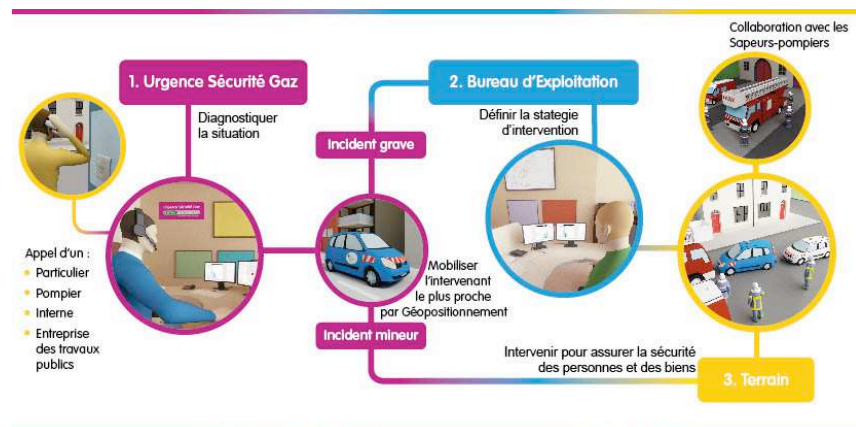
Figure 3. Lorsqu'un appel arrive signalant un incident, par exemple une fuite de gaz, il est pris en charge par un service dédié, « Urgence Sécurité Gaz » (USG). L'USG qualifie la gravité de l'incident et le transmet au Bureau d'Exploitation (BEX), le service qui sur une zone géographique donnée, a la vision de l'ensemble de l'état du réseau et peut le piloter ; le BEX étant également en charge de piloter la gestion des incidents, nommée « intervention sécurité » (cf. chapitre 2), il confie l'intervention à l'un des intervenants sécurité qui se rend sur le terrain et assure la gestion de l'intervention en étant accompagné à distance par le BEX. La gravité de l'incident peut être telle que les pompiers sont impliqués, ce qui s'inscrit dans le cadre d'une démarche particulière dite « Procédure Gaz Renforcée » (PGR).
