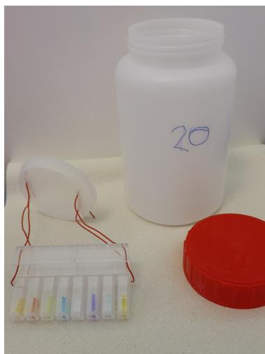
**Fig. III.19 – Support permettant l'exposition du Nez à une culture en milieu liquide.** Le montage se compose d'un flacon en PVC comportant un bouchon interne et un bouchon externe pour maximiser l'étanchéité. Un support dédié à l'accueil des monolithes est fixé au bouchon interne *via* deux fils en PVC. La forme du support permet d'isoler chaque monolithe, limitant ainsi les interactions entre eux et les protégeant d'éventuels gouttes de sang lors de l'agitation.
