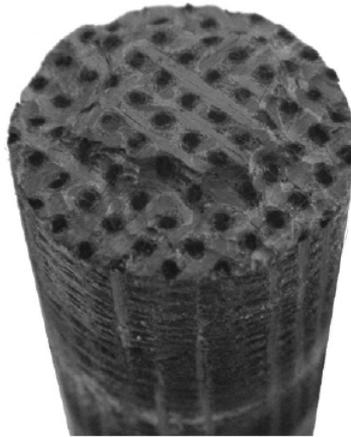
FIGURE 1.2 – Structure d’un matériau composite C/C d’un bouclier thermique [YZX<sup>+</sup>08].
