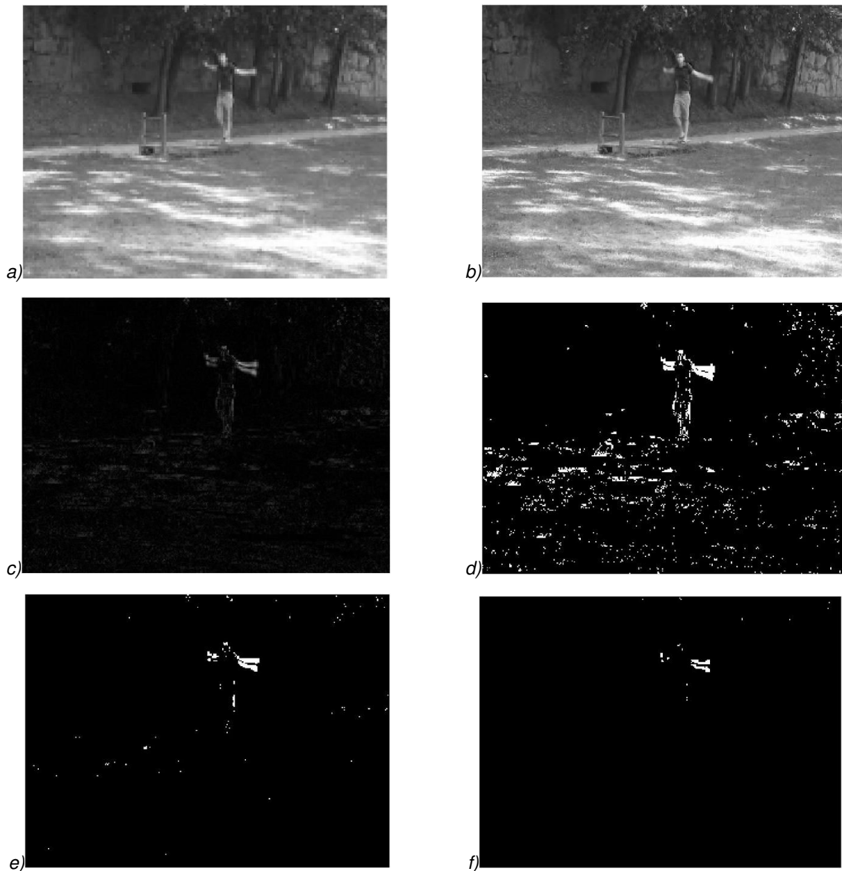
Figure 146 : (a) Première image moyennée sur 2x2 pixels (donc 120x160 pixels) (b) deuxième image (240x320 pixels) (c) différence a-b (d) a-b seuillée à 0.1 comme 1-d) (e) a-b seuillée à 0.2 (f) a-b seuillée à 0.3 (g) a-b seuillée à 0.4. Les images résultats ont autant de pixels que la vidéo initiale : 240x320.
