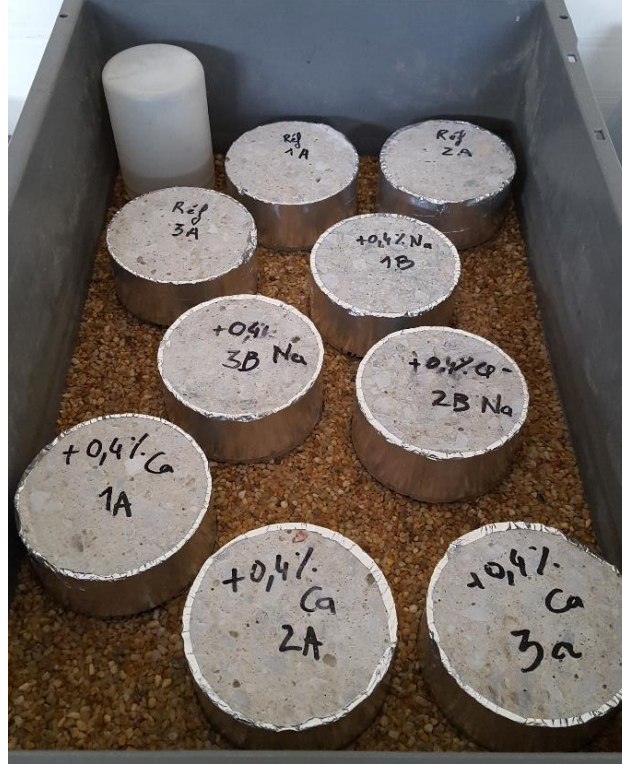
Figure 37 - Essai d'absorption capillaire sur béton
