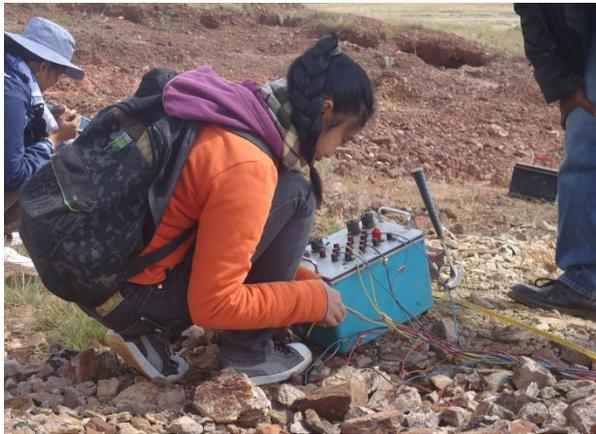
**Photo 6 : Branchement du câble multiélectrode au multinode**
