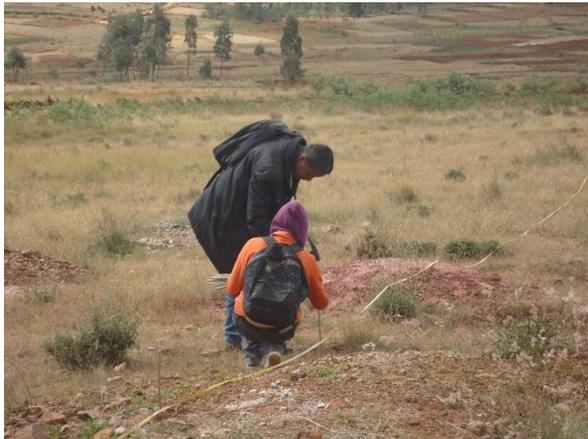
**Photo 4 : Implantation des électrodes**
