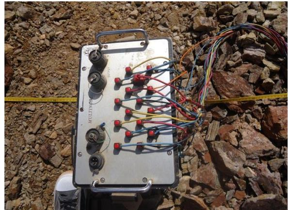
**Photo 7 : câble multiélectrode branché au multinode branché**
