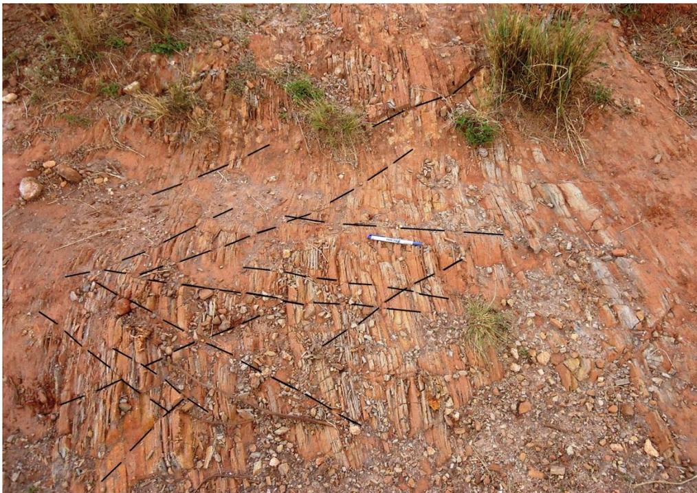
**Photo 22 : fractures observées sur les quartzites (les traits en noir sont tracés dans le but de mettre en relief les fractures et leur continuité)**
