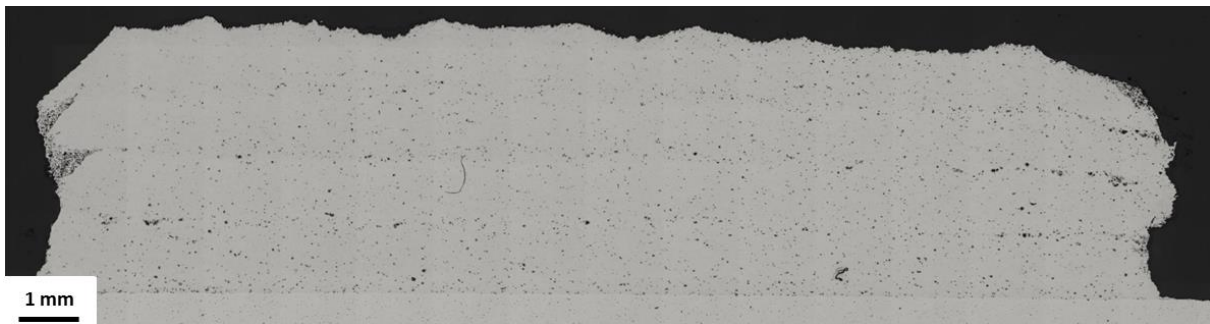
Figure IV. 19 : Cartographie d'un dépôt en coupe réalisé en 4 passes (coupe perpendiculaire au sens de projection)
