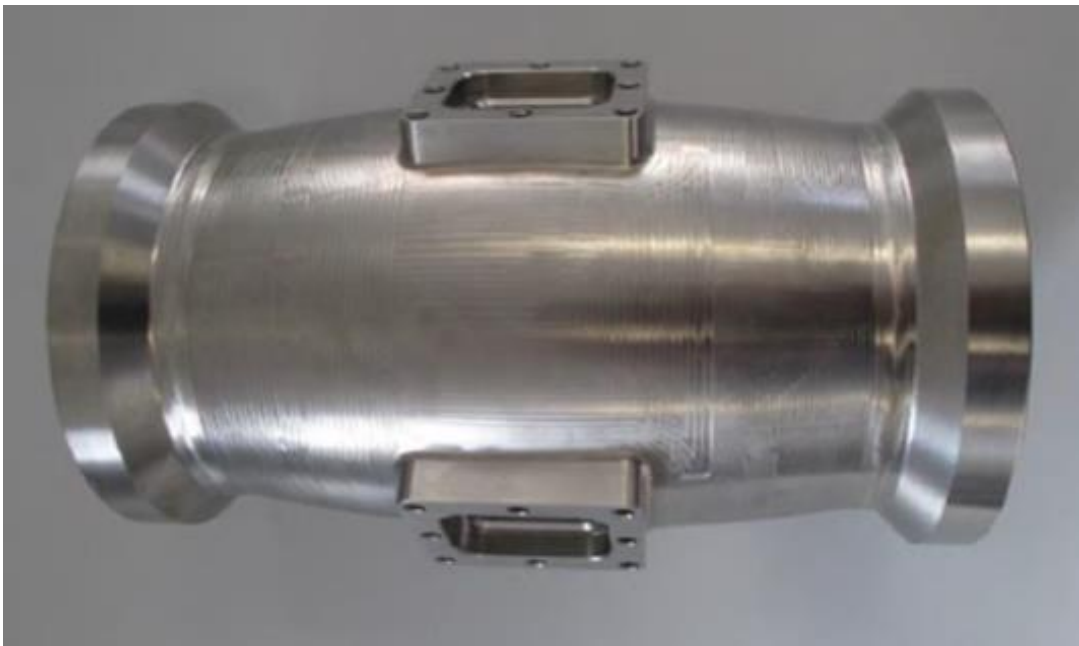
Figure I. 12 : Pièce réalisée par Impact Innovations en titane (environ 7kg).
