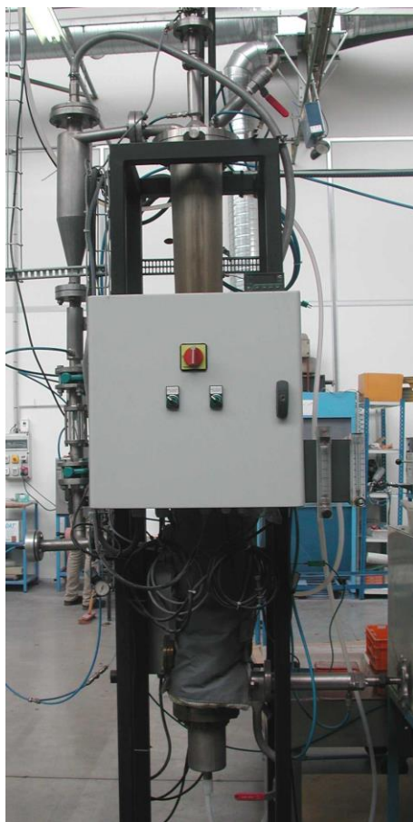
Figure III. 4 : Photo du lit fluidisé de Lifco.
