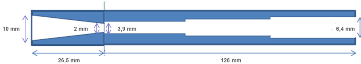
Figure II. 13 : Schéma de la buse du système CenterLine (Ultiflow).
