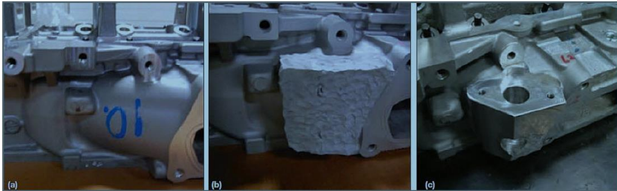
Figure I. 11 : Ajout par fabrication additive par cold spray sur une pièce a) avant projection, b) après projection, c) après usinage, [33].
