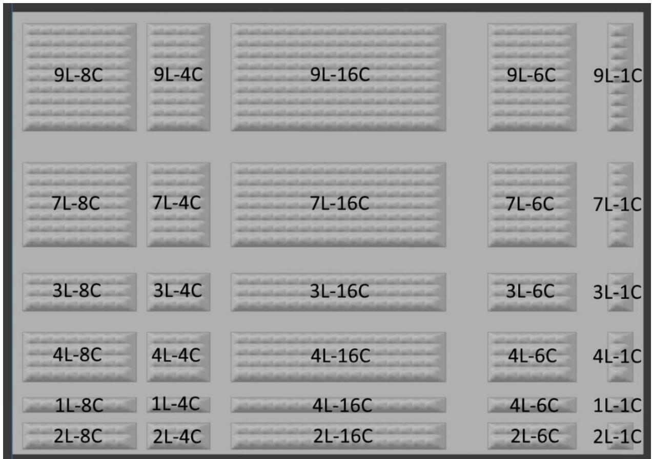
Figure 43 : Cartographie des blocs reliefs disposés sur une surface plane et identifiés par le nombre de briques en ligne et en colonne.
