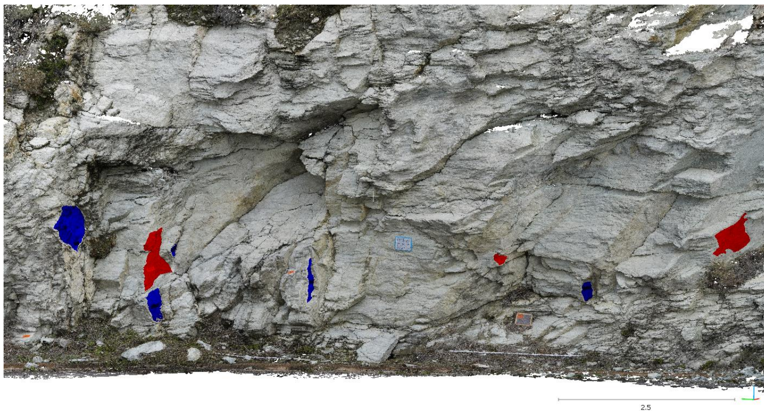
Figure 102 : Cartographie 3D des zones amiantées sur l’affleurement 2BFC728, repérées par les géologues in situ : CF en bleu et FNV en rouge.
