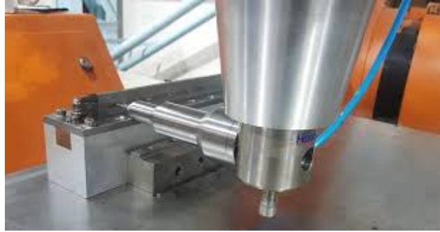
Figure 1.12 – Système de martelage mécanique [Hönnige+2017]
