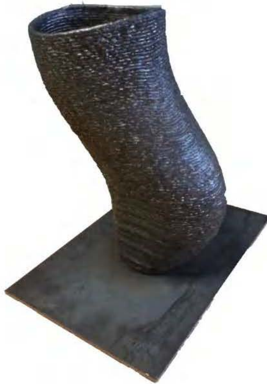
Figure 4.16 – "Trompe d'éléphant" avec un facteur d'échelle 2.5 plus grande
