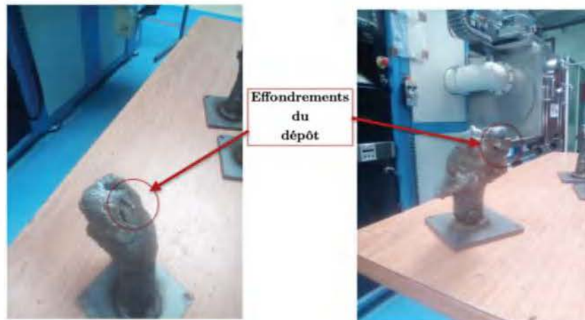
Figure 4.23 – Effondrement du dépôt lors de la fabrication continue
