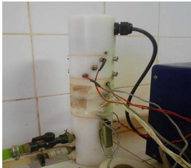
Figure 13 : Disposition des mâchoires et du téflon isolant
