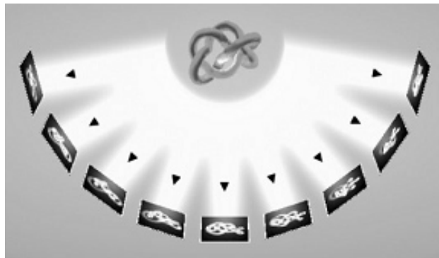
Figure 2.13 : Schéma de principe de l'acquisition de plusieurs images à différents angles pour reconstituer un objet en 3D. Principe utilisé dans la tomographie électronique, [TaylorLab]
