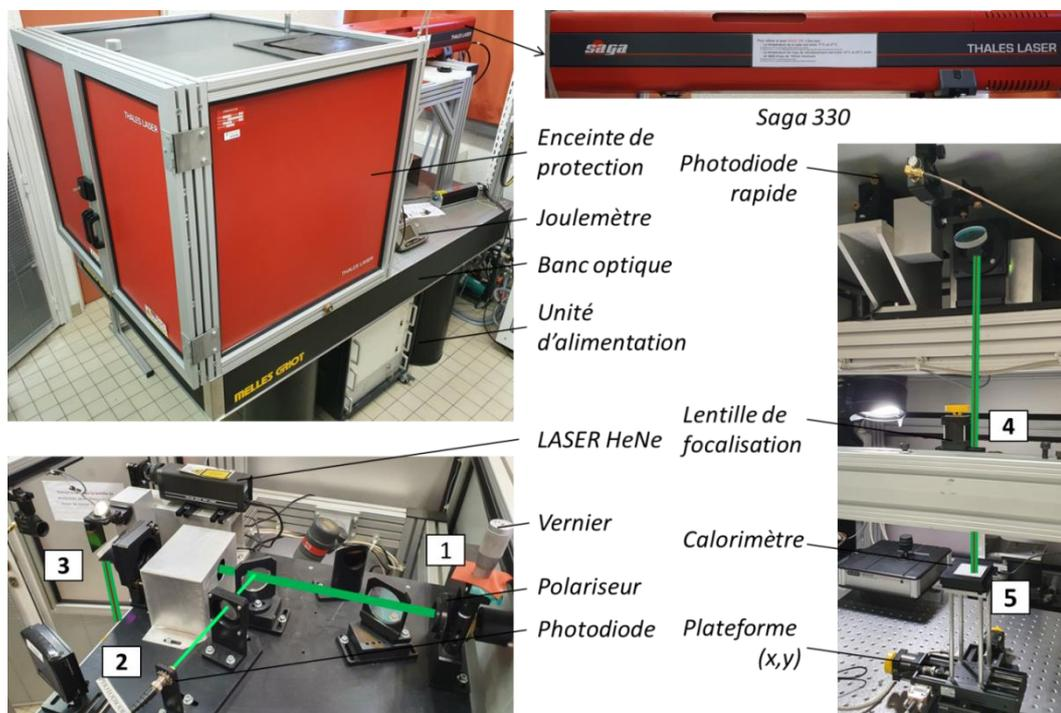
Figure II.8 : Installation LASAT du centre des matériaux de Mines ParisTech
