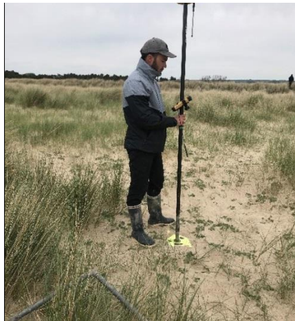
Figure 91. Acquisition des points de contrôle au sol par l'intermédiaire d'un SMNSD. Source : Mury et al. (2019b).
