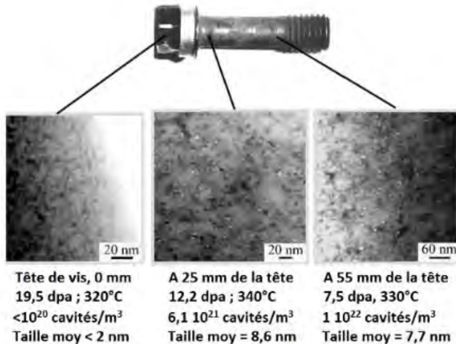
Figure I-22 : Caractérisation par microscopie électronique en transmission de plusieurs zones d'une vis irradiée en REP. Différentes populations de cavités sont présentes en fonction de la dose et de la température d'irradiation (Edwards et al. 2003).
