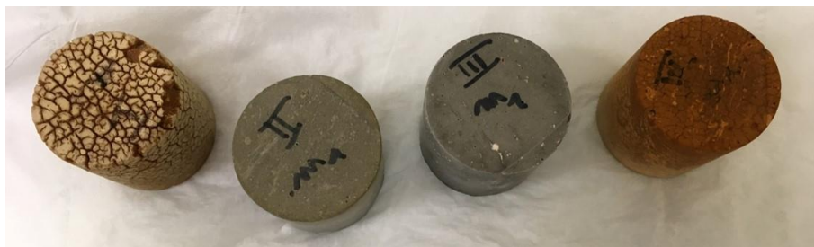
Figure II - 6 : Echantillons sortis des solutions agressives au terme de l'expérience pour être pesés et analysés
