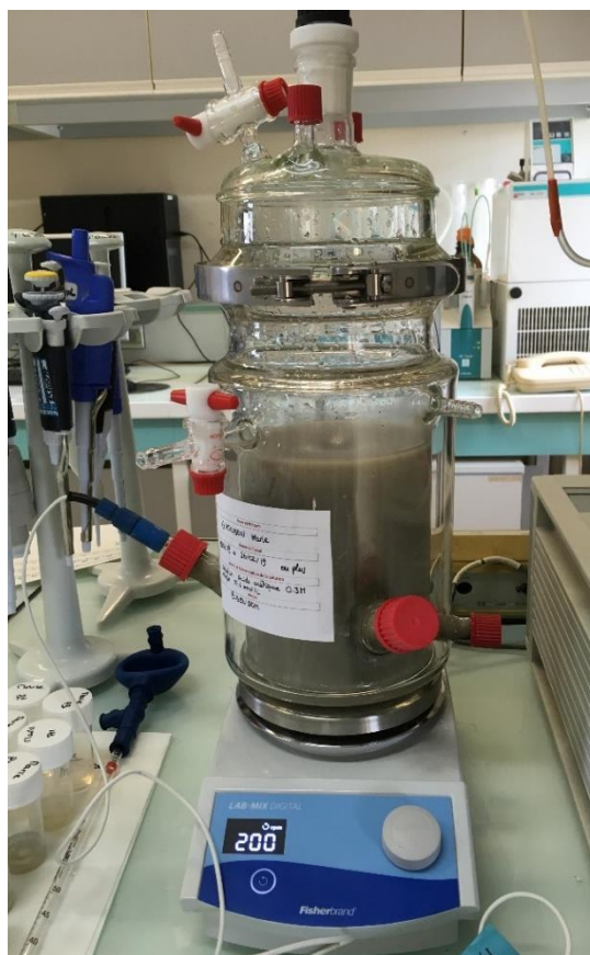
Figure II - 8 : Dispositif expérimental pour l'étude de la dégradation de poudre de pâte de CEM I par une solution d'acide acétique
