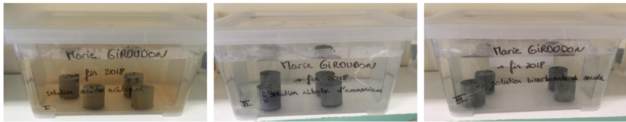
Figure II - 5 : Bacs contenant les solutions à base d'acide acétique, de nitrate d'ammonium et de bicarbonate de sodium et les échantillons de pâtes de CEM I
