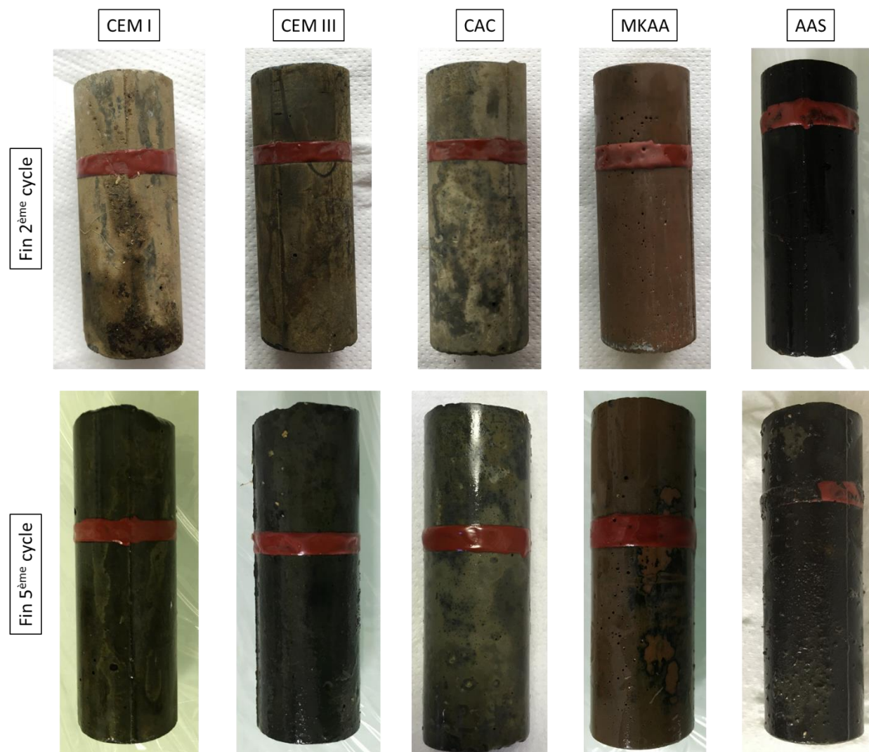
Figure IV - 7 : Echantillons de matériaux après le deuxième cycle et le cinquième cycle de digestion de brisure de maïs
