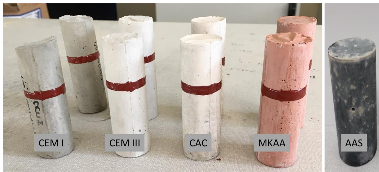
Figure IV - 4 : Échantillons de matériaux avant insertion dans la brousse de maïs en digestion – de gauche à droite : pâtes de CEM I, CEM III, CAC, MKAA et AAS
