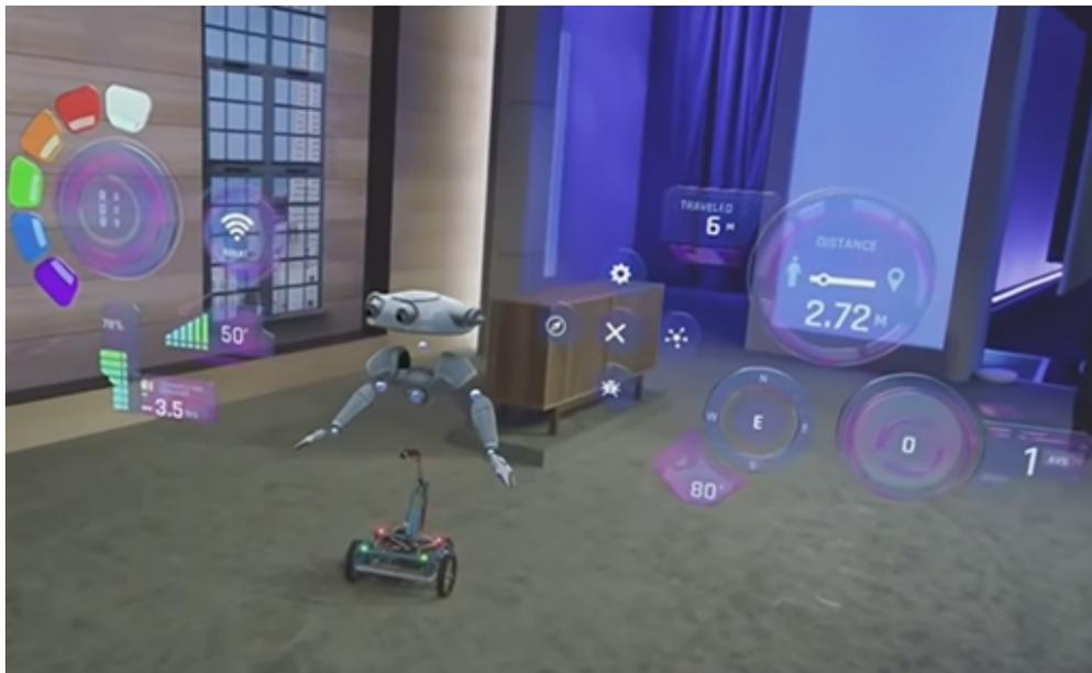
FIGURE 3.4 – Le robot mixte B15 de Microsoft. Ce robot est composé d'une partie réelle mobile et d'une partie virtuelle rendue par un Hololens.
