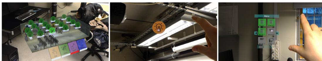
FIGURE 2.18 – Modèles d’interaction en réalité augmentée avec un bâtiment connecté [ARE<sup>+</sup>17]. A gauche, l’utilisateur interagit avec le jumeau virtuel du bâtiment. Au centre, l’utilisateur interagit avec une icône flottante. A droite, l’utilisateur interagit avec un menu déroulant.
