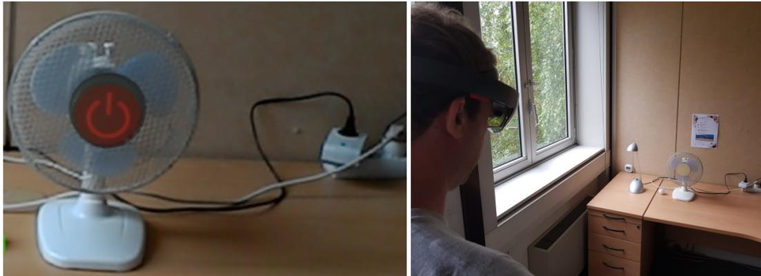
FIGURE 4.1 – Aperçu du système ventilateur mixte. A gauche, la vue de l'utilisateur augmentée par l'Hololens sur le ventilateur mixte. L'Hololens affiche en stéréoscopie le bouton virtuel du ventilateur mixte sur sa surface. A droite, vue d'ensemble de l'utilisateur équipé de l'Hololens et observant le ventilateur mixte branché à une prise connectée.
