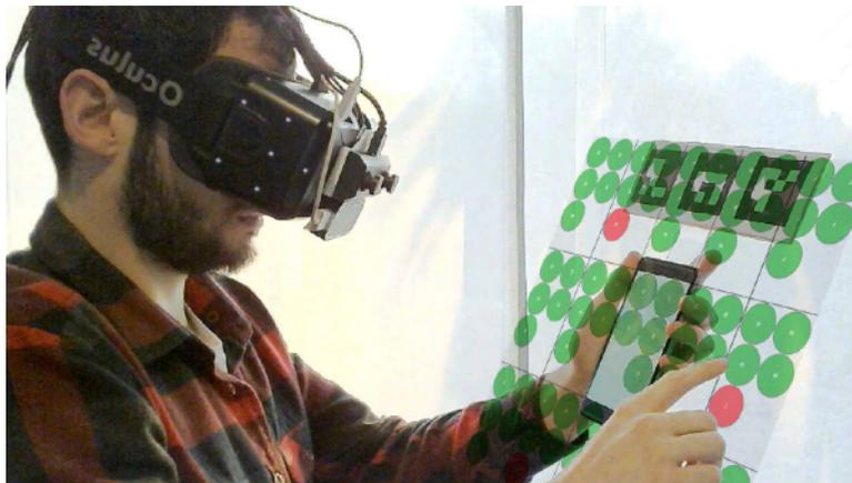
FIGURE 2.27 – Le système VESAD par Normand et al. [NM18] permet d'augmenter le champ de vision d'un téléphone intelligent à l'aide d'un visiocasque.
