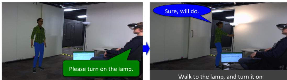
FIGURE 2.19 – Un agent incarné piloté par la voix commande une lampe connectée [KBH<sup>+</sup>18].
