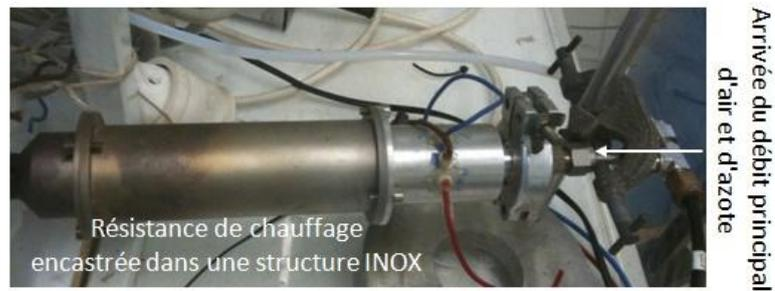
Figure 43: Résistance de chauffage des gaz incorporée dans une structure INOX
