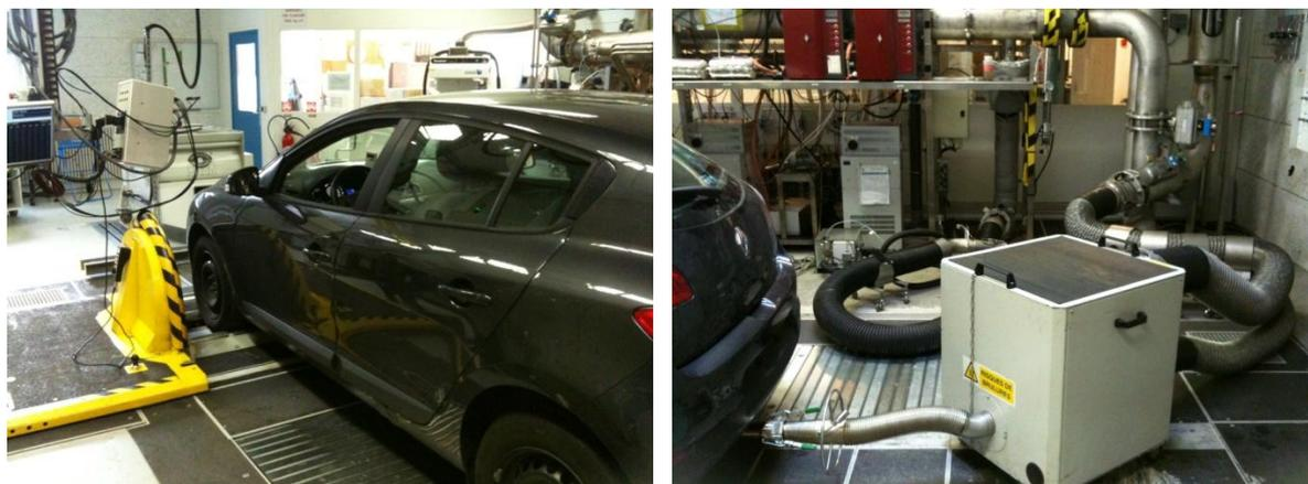
Figure 149: Images d'un véhicule installé sur le "Banc à Rouleaux, avec son dispositif de prélèvement des gaz à analyser
