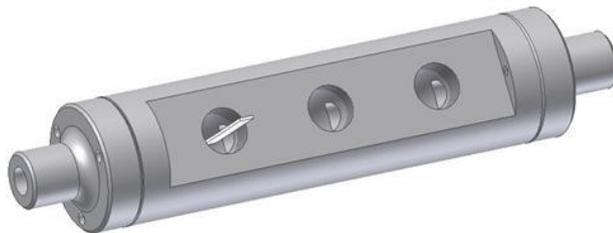
*Figure 41: Porte échantillon du banc de tests avec une section intérieure de passage des gaz adaptée à la géométrie des capteurs pour garder une vitesse des gaz constante tout au long de leur passage*
