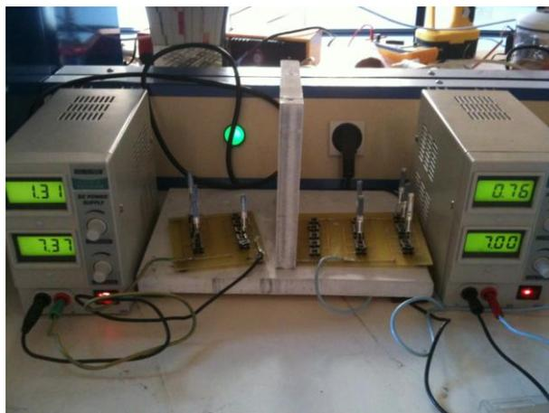
*Figure 145: Dispositif de vieillissement des capteurs permettant de maintenir les capteurs à une température de fonctionnement désirée*
