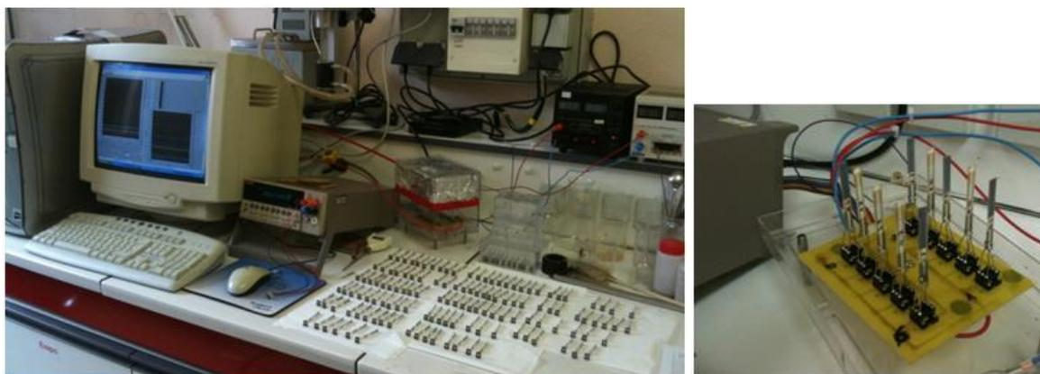
Figure 52: (à gauche) = Dispositif de tri statistique des capteurs sous une concentration de gaz et une température des capteurs données
