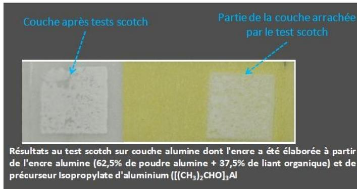
Figure 81: Résultats des tests d'adhérence au scotch sur couche d'alumine dont l'encre a été élaborée à partir de l'encre alumine (62,5% de poudre alumine + 37,5% de liant organique) et de précurseur Isopropylate d'aluminium  $[(CH_3)_2CHO]_3Al$  et recuite à 750°C pendant 1 heure
