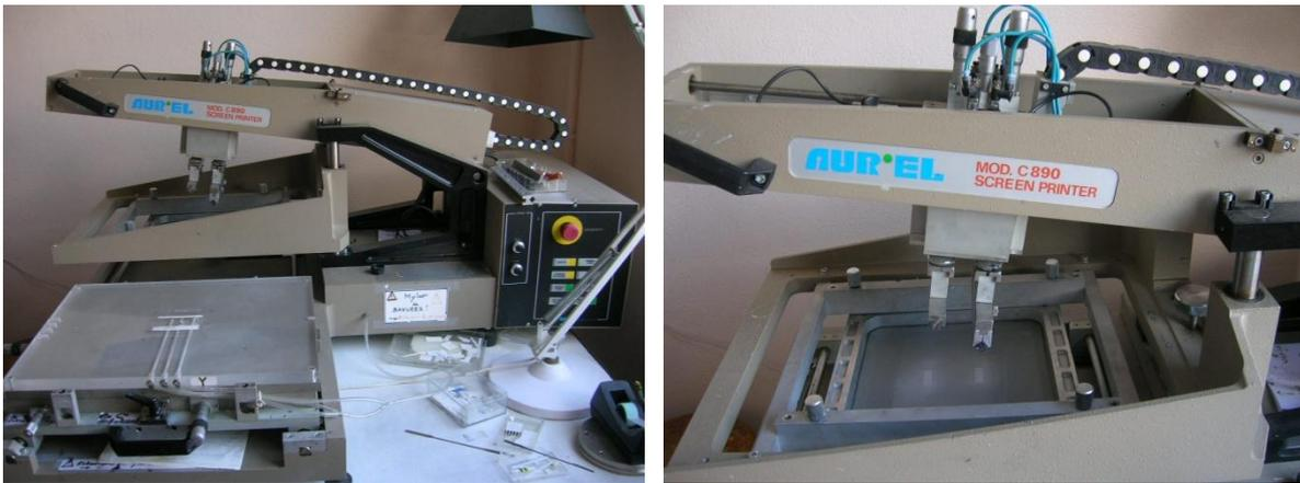
Figure 26: Machine de sérigraphie semi-automatique "Aur'el Model C890"
