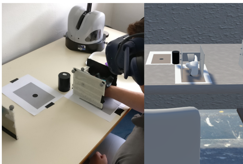
FIGURE 2.9 – Installation expérimentale de l'étude de la fidélité biomécanique d'une tâche en environnement virtuel.
