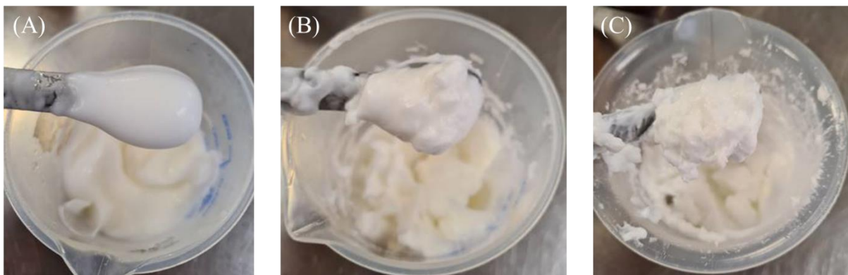
Figure 4.3 : Emulsions inverses concentrées à différentes fractions volumiques aqueuses (A) 85% (B) 90% et (C) 96%.
