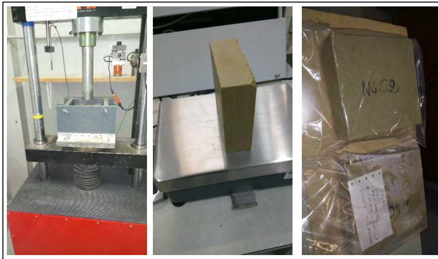
Figure II-11 : Fabrication d'éprouvettes parallélépipédiques pour mesures de conductivité thermique et de capacité de tampon hydrique (MBV)
