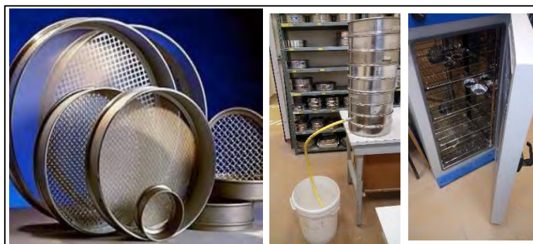
Figure II-6 : Dispositif de tamisage par voie humide
