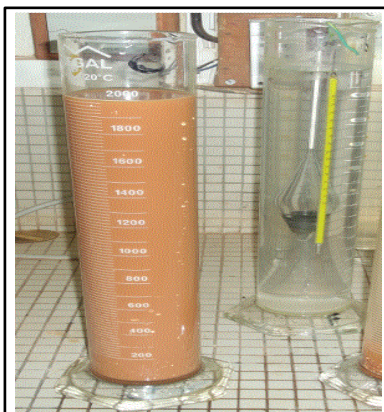
Figure II-7 : Dispositif d'analyse granulométrique par sédimentation
