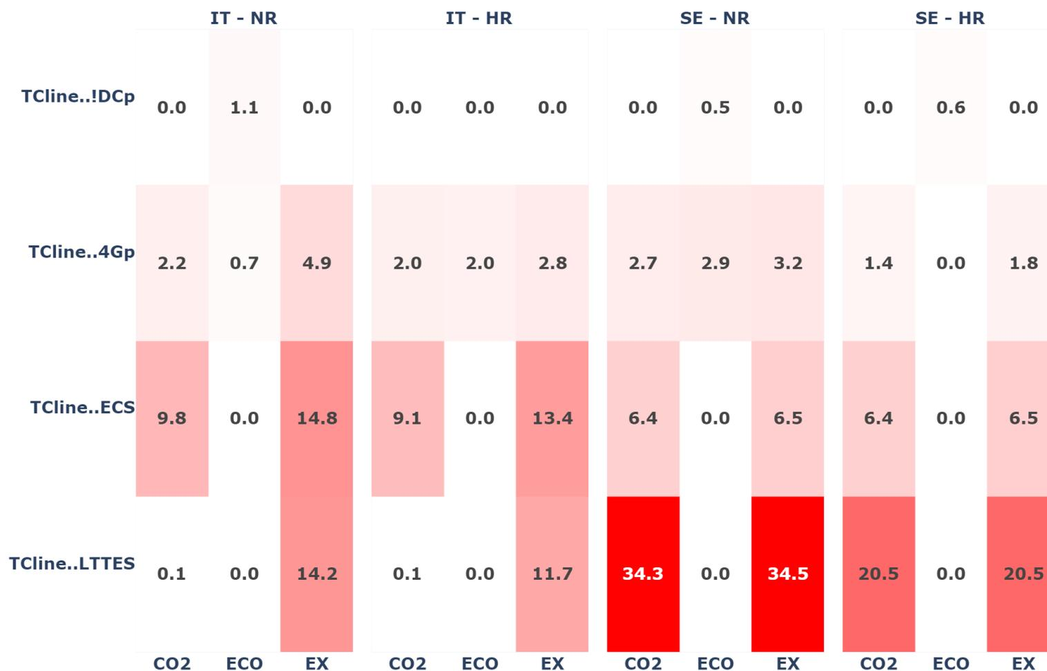
Figure IV-5: Energie annuelle déchargée des composants *Storage* en fonction du couple (pays, scénario de rénovation) et de la fonction objectif – architecture NN\_4G\_DC
