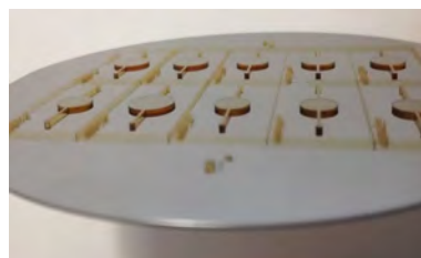
FIGURE 2.12 – Moule Si/SU8 des biopuces à optode
