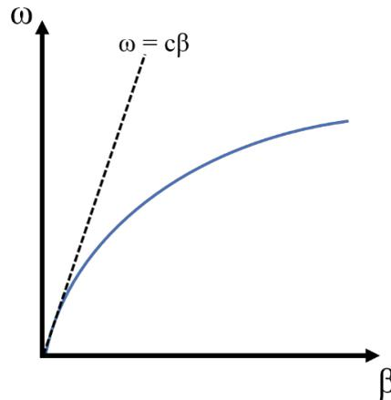
Figure 1.4 : Courbe de dispersion d'une onde plasmon de surface pour une interface métal/diélectrique. La droite en pointillé représente la relation de dispersion de la lumière dans le milieu diélectrique.
