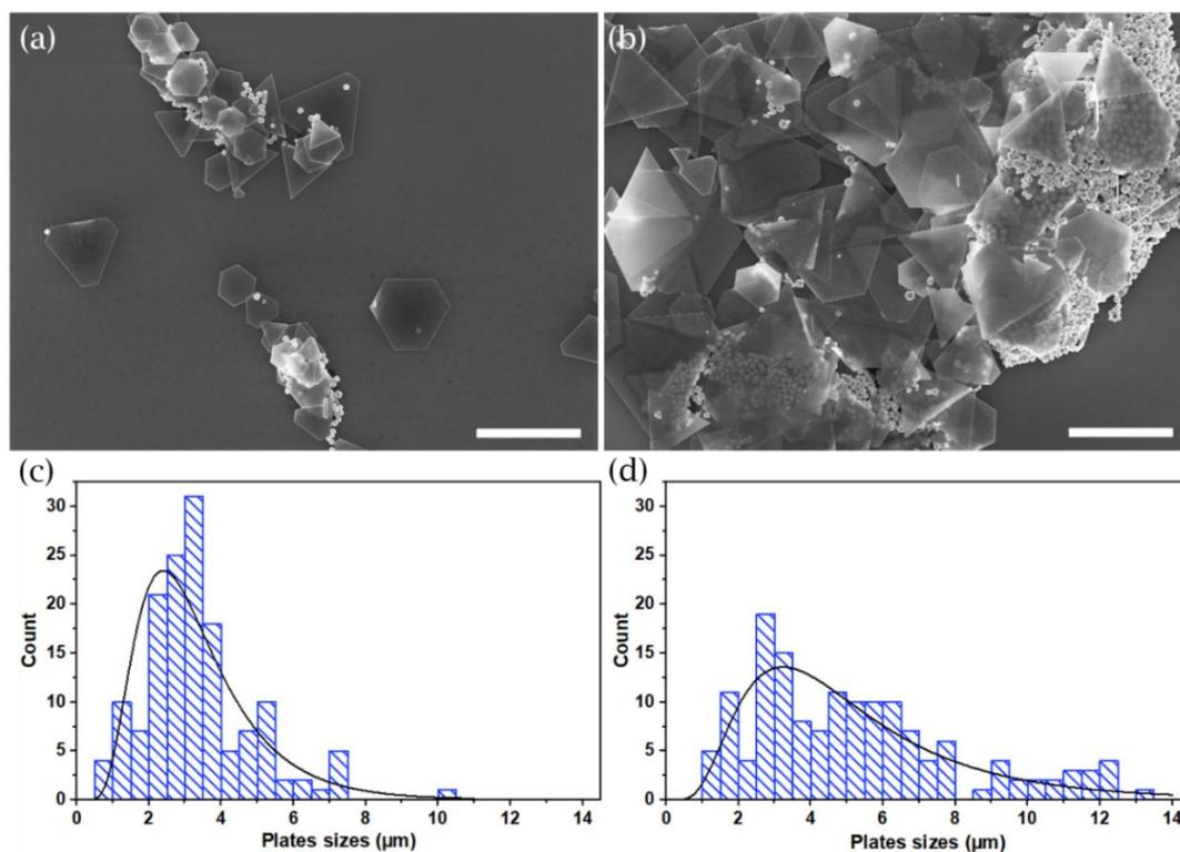
Figure 2.1 : Images SEM de microplaquettes obtenues par les protocoles avant centrifugation donnant de petits (a) et de grands (b) cristaux. Échelles 10  $\mu\text{m}$ . (c) et (d) histogrammes de tailles des synthèses (a) et (b) respectivement.
