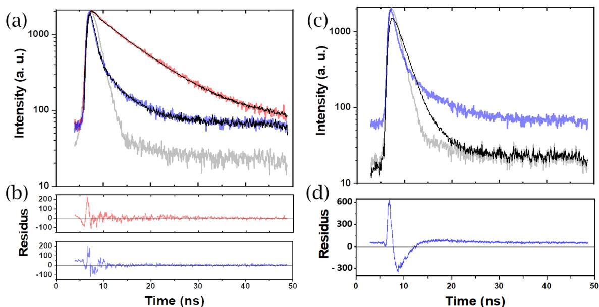
Figure 4.16 : (a) Mesures de la durée de vie de la fluorescence et (b) ajustement des résidus des clusters  $AuNC_a$  (en bleu) et  $AuNC_i$  d'indole (en rouge). Dans (a), les fits sont en noir et la référence du POPOP utilisée est en gris. (c) Ajustement de la courbe de décroissance exponentielle avec une exponentielle simple et (d) ajustement du résidu associé.
