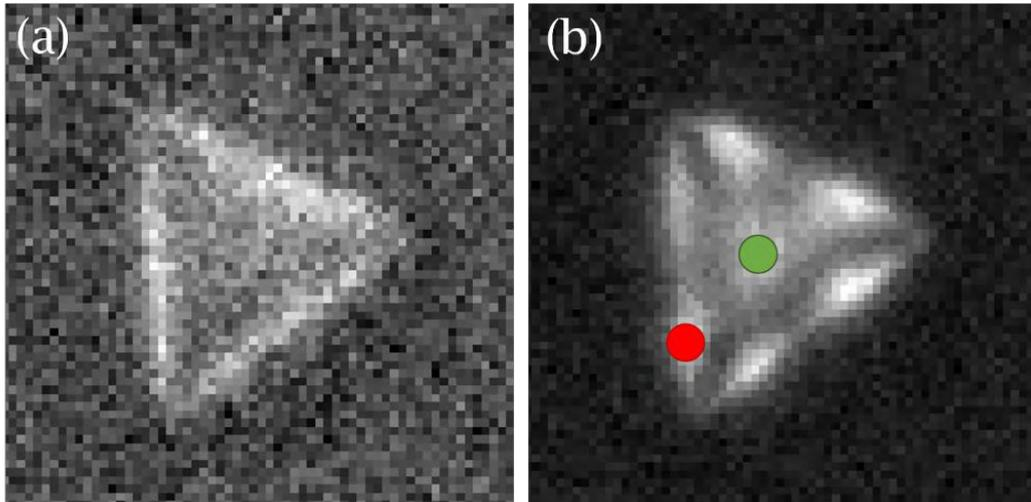
*Figure P.4 : Cartes d'intensité CL d'un nanoprisme de 560 nm de côté à : (a) 475 nm et (b) 525 nm. Les ronds de couleurs rouge et vert représentent la position voulue des nanodiamants rouge et vert respectivement.*
