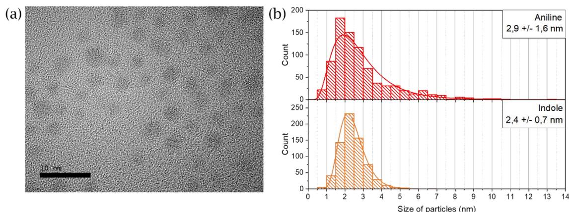
Figure 4.4 : (a) Image HRTEM typique des AuNC synthétisés. (b) Distributions de taille des AuNC<sub>a</sub> (en rouge) avec une taille moyenne de  $2,9 \pm 1,6$  nm et des AuNC<sub>i</sub> (en orange) avec une taille moyenne de  $2,4 \pm 0,7$  nm.
