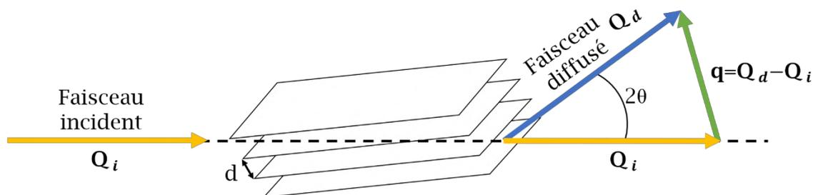
Figure 2.4 : Diffraction des rayons X par un réseau de plans  $hkl$ . Représentation du vecteur de diffusion  $\mathbf{q}$  en fonction des vecteurs d'onde incidents et diffusés  $\mathbf{Q}_i$  et  $\mathbf{Q}_d$ .
