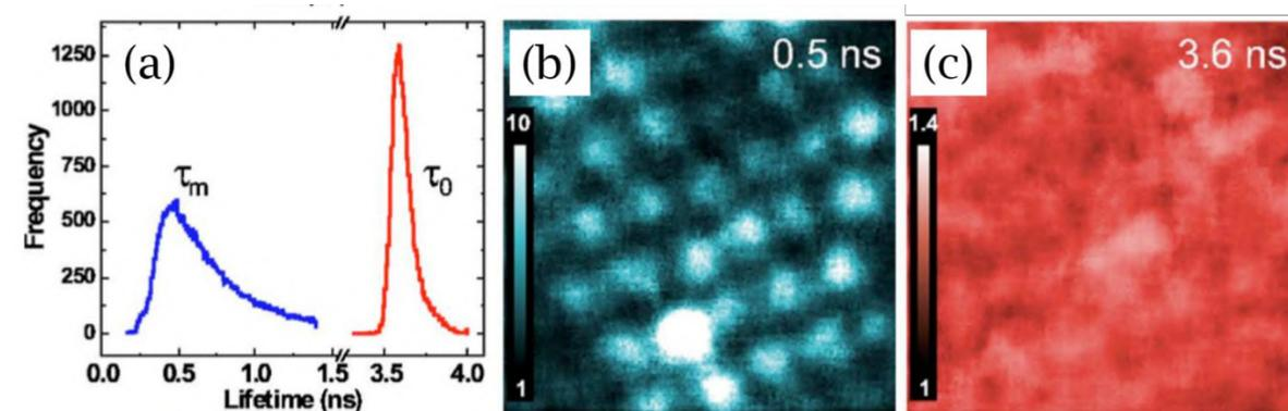
Figure 1.23 : (a) Histogramme des composantes des durées de vie ( $\tau_m$ ,  $\tau_0$ ) obtenues à partir d'ajustements bi-exponentiels des pixels de la zone de balayage. (b) Carte spatiale de l'intensité pré-exponentielle normalisée pour la composante  $\tau_m$  0,5 ns. (c) comme (b) pour la composante 3,6 ns  $\tau_0$  montrant l'homogénéité dans la région. Figures reprises avec autorisations de la référence [132].
