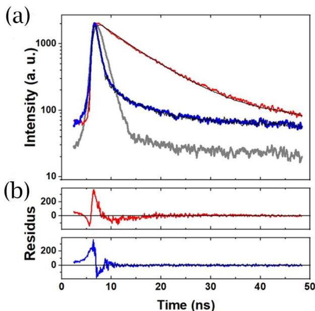
Figure 4.17 : (a) Mesures de la durée de vie de la fluorescence et (b) ajustement des résidus des clusters AuNC<sub>a</sub> (bleu) et AuNC<sub>i</sub> (rouge) fonctionnalisés avec de la biotine en rouge et bleu respectivement. Dans (a), les ajustements sont en noir et la référence du POPOP utilisée est en gris.
