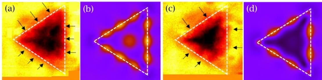
Figure 1.19 : Images de fluorescence enregistrées sur le dessus de la cavité prismatique de 900 nm de long pour différents filtres passe-bande de 10 nm de large centrés à 650 (a), et 800 nm (c). Cartes du taux de décroissance radiative normalisé calculé pour des émetteurs scalaires positionnés à 40 nm au-dessus de la structure et émettant à 650 (b) et 800 nm (d). Figures reprises avec autorisations de la référence [110].
