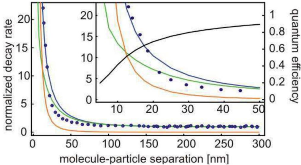
Figure 1.18 : Taux de décroissance de la fluorescence pour une approche de la distance particule-fluorophore. Les points bleus indiquent le taux de décroissance expérimental  $\Gamma_T$  et les lignes donnent les valeurs calculées de  $\Gamma_m$  (orange),  $k_{nr}$  (vert) et  $\Gamma_T$  (bleu). Encadré : parcelle agrandie avec rendement quantique  $Q_m$  (noir). Figure reprise avec autorisations de la référence [106].
