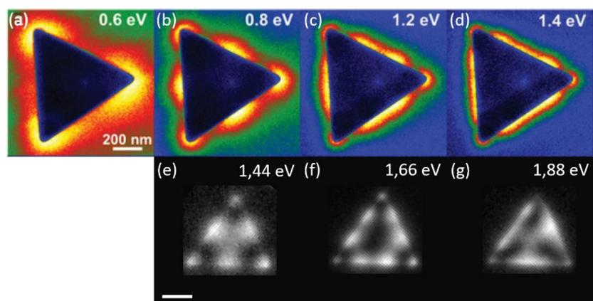
Figure 5.12 : (a-d) Cartes EELS d'un prisme d'or de 830 nm à différentes énergies. Reproduites avec autorisation de la référence [7]. (e-g) Cartes CL d'un prisme d'or de 560 nm à différentes énergies. Les barres d'échelle font 200 nm.
