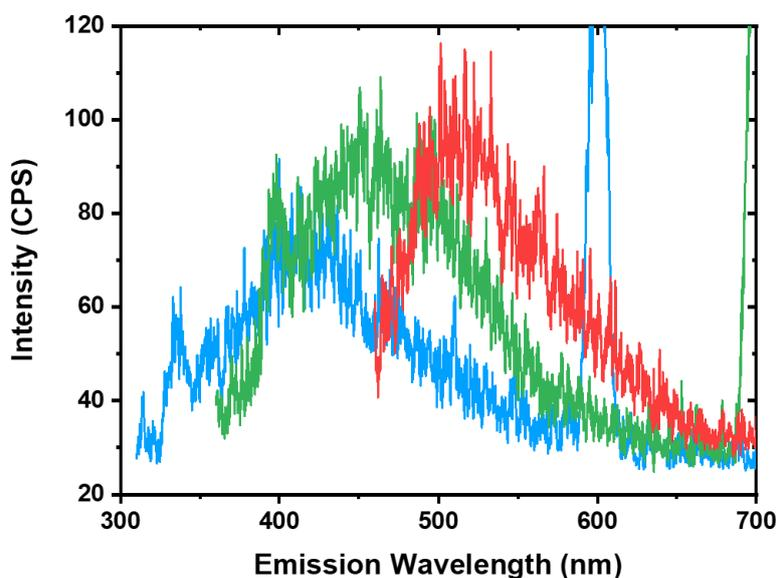
Figure 4.1 : Spectres de fluorescence de la solution orangée observée (après la diminution de la concentration du réducteur à 25 mM et du pH à 3, obtenus) pour des excitations à  $\lambda_{ex1} = 300$  nm (en bleu),  $\lambda_{ex2} = 350$  nm (en vert) et  $\lambda_{ex3} = 410$  nm (en rouge). Les pics fins à 600 nm et 700 nm sont les harmoniques des longueurs d'onde d'excitation  $\lambda_{ex1}$  et  $\lambda_{ex2}$ .
