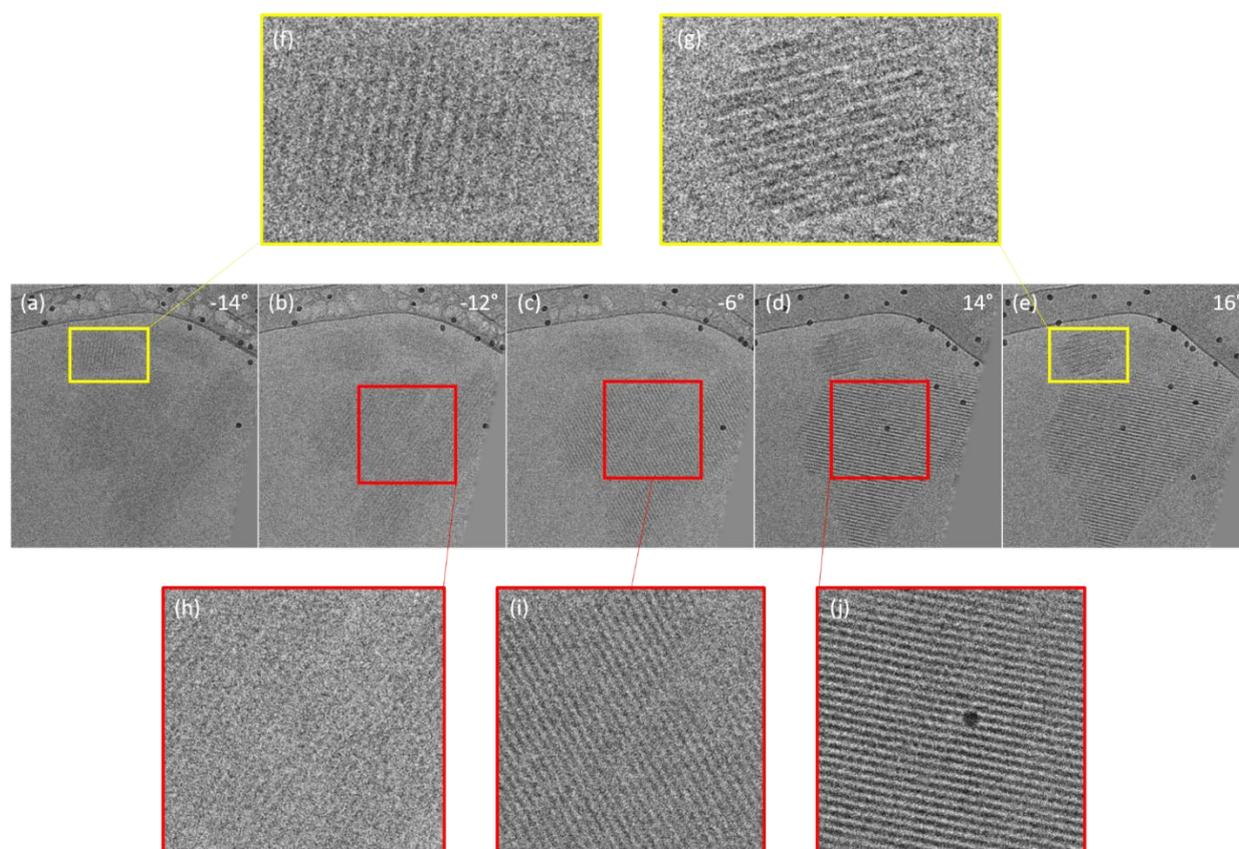
Figure 3.24 : Images cryoTEM obtenues à partir d'une vidéo de cryotomographie pour cinq tilts : (a)  $-14^\circ$ , (b)  $-10^\circ$ , (c)  $-6^\circ$ , (d)  $14^\circ$  et (e)  $16^\circ$ . (f) et (g) respectivement zoom des rectangles jaunes sur les images (a) et (e). (h), (i) et (j) respectivement zoom des rectangles rouges sur les images (b), (c) et (d).
