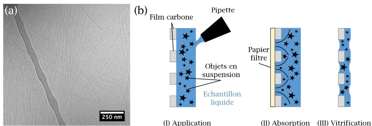
Figure 2.9 : (a) Image cryoTEM de fibres composées de peptides sur une grille « *lacey* ». Image cryoTEM reproduite avec autorisation de la référence [15]. (b) Schéma de principe de préparation d'un échantillon en trois étapes : (I) le dépôt de la solution, (II) l'absorption de l'excès et (III) la vitrification.
