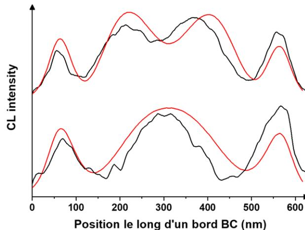
Figure 5.10 : Coupe de l'intensité CL le long du côté BC du prisme des cartes mesurées (en noir) et simulées (en rouge) pour  $\lambda_s = 680$  nm (en haut) et  $\lambda_s = 830$  nm (en bas).
