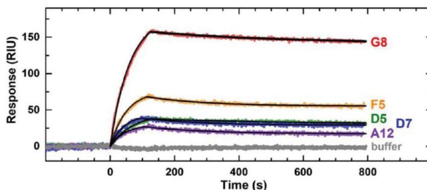
Figure 1.40 : Sensogrammes SPR pendant les phases d'adsorption et de désorption surveillant les interactions entre les protéines  $\alpha$ -Rep immobilisées et les nanoparticules d'or stabilisées au citrate ( $[Aucit] = 10 \text{ nM}$ ). Les lignes noires pleines sont les ajustements exponentiels des phases d'association et de dissociation. Figure reprise avec autorisations de la référence [167].
