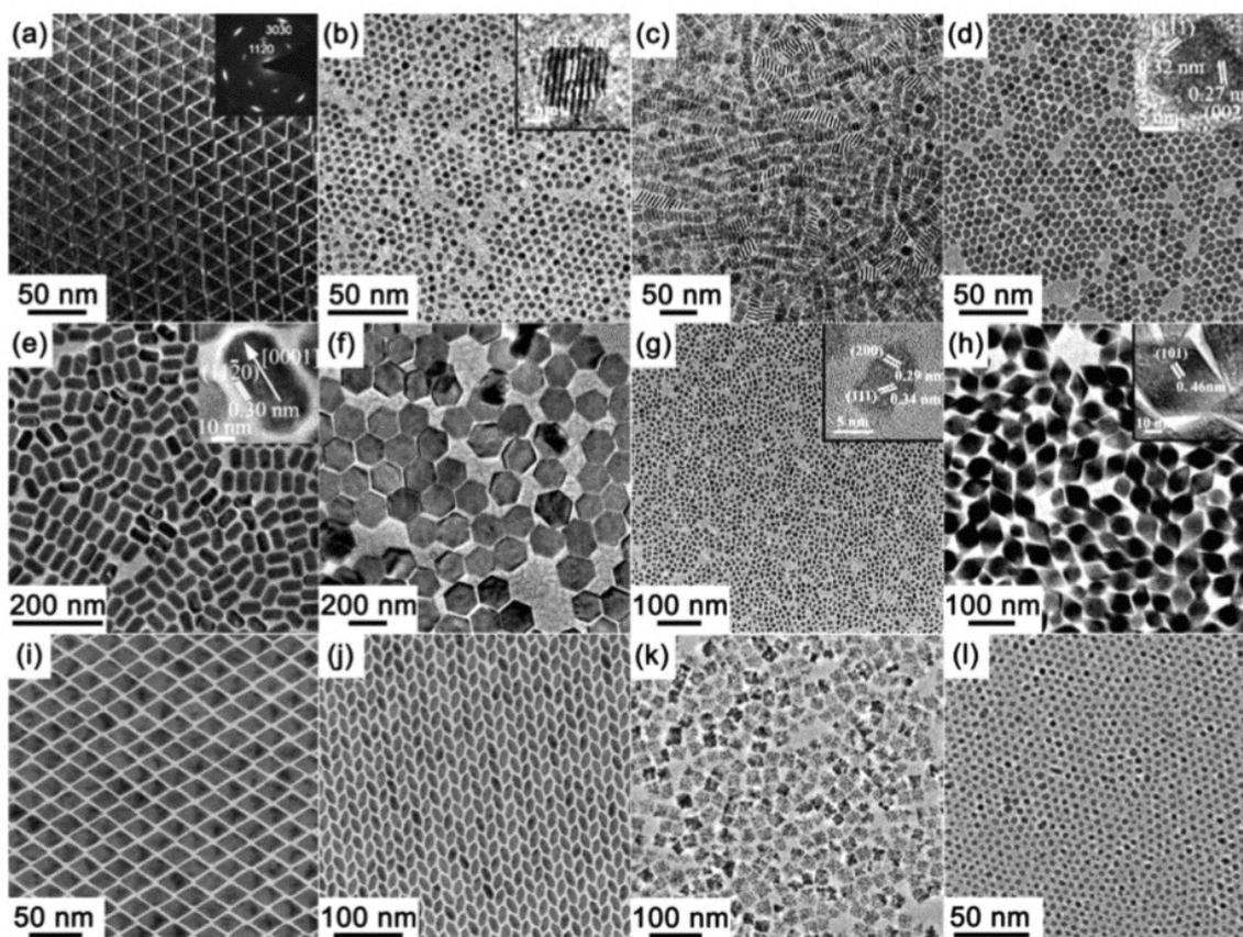
Figure 1.12 : Image TEM de particules de différentes tailles de (a)  $\text{LaF}_3$ , (b)  $\text{LaOF:Eu}$ , (c)  $\text{LaOCl}$ , (d)  $\text{NaYF}_4$  cubiques, (e)  $\text{NaYF}_4$  hexagonales, (f)  $\text{NaYF}_4:\text{Yb,Er}$  hexagonales, (g)  $\text{KPrF}_4$ , (h)  $\text{LiErF}_4$ , (i)  $\text{DyF}_3$ , (j)  $\text{TbF}_3$ , (k)  $\text{CeO}_2$  et (l)  $\text{CeO}_2$ . Figures reprises avec autorisations de la référence [41].
