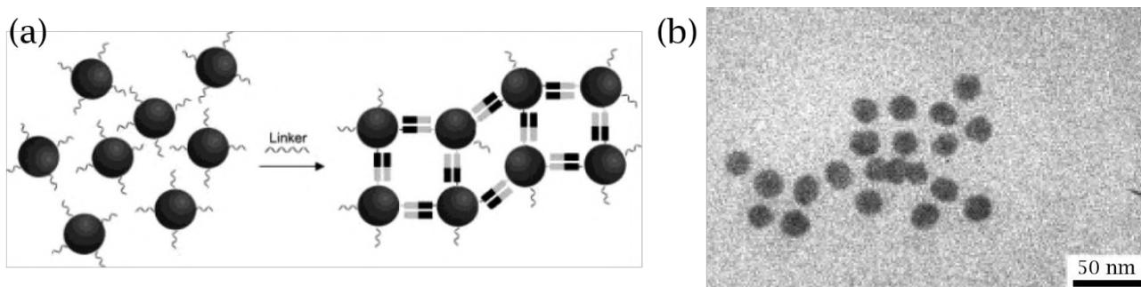
Figure 1.32 : (a) schéma de principe de l'assemblage de nanoparticules d'or dirigées par liens nanométriques ceintures et armatures. (b) images TEM de l'assemblage. Les particules sont séparées de 7 nm. Schéma et image TEM repris avec autorisations de la référence [156].
