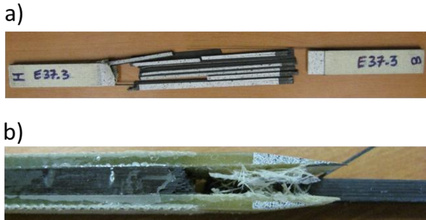
Figure I-13 : Exemples de ruptures prématurées des éprouvettes [0^\circ]_{16} .
