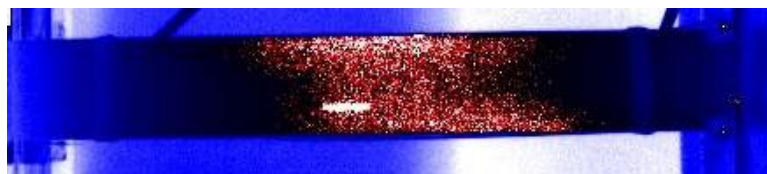
Figure I-18 : Défaut (en blanc) identifié par thermographie passive dans la zone utile d'une éprouvette [0^\circ]_4 , quelques dixièmes de secondes avant la rupture en traction.
